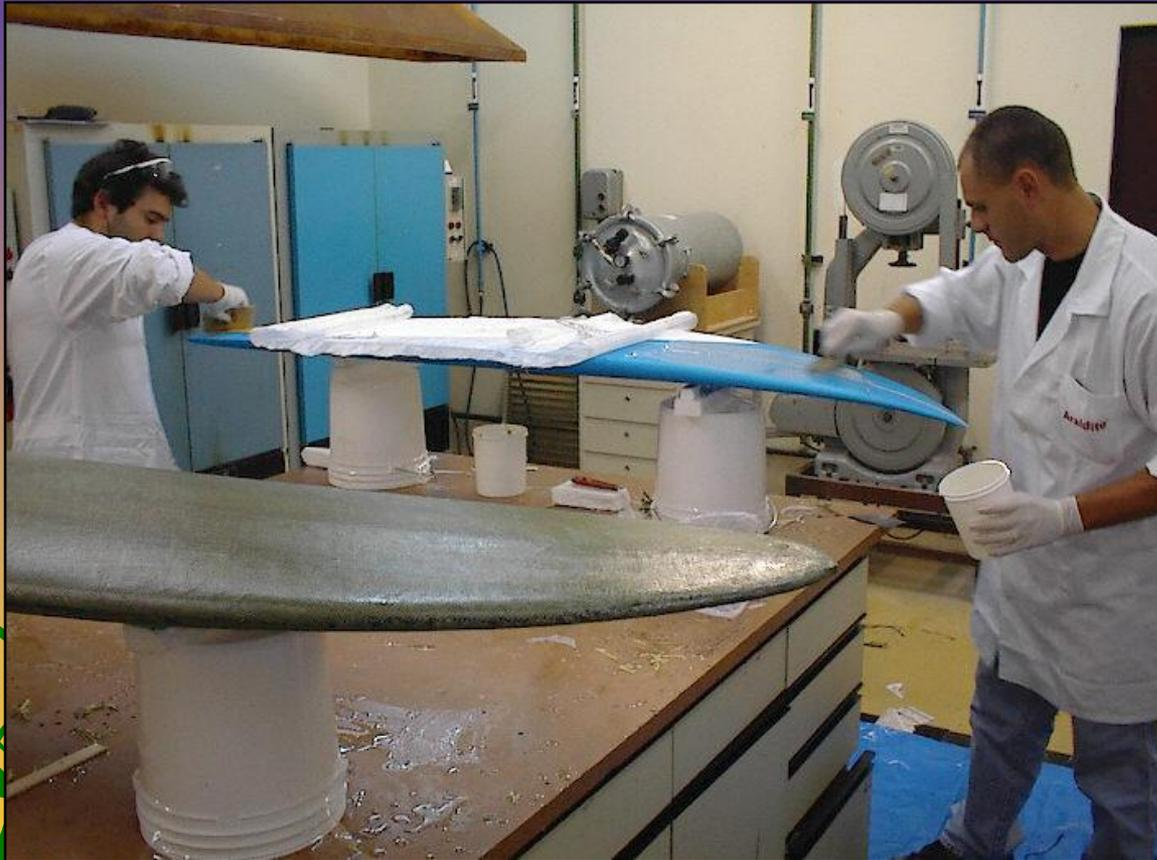
.Tom e Rudy, laminam em outra prancha um tecido de vidro 120gr fornecido pela Maxepoxi, com **Araldite LY-1316** e **Endur. XR-1837** (100:35) um bloco de Styrofoam fornecido pela EPS.
