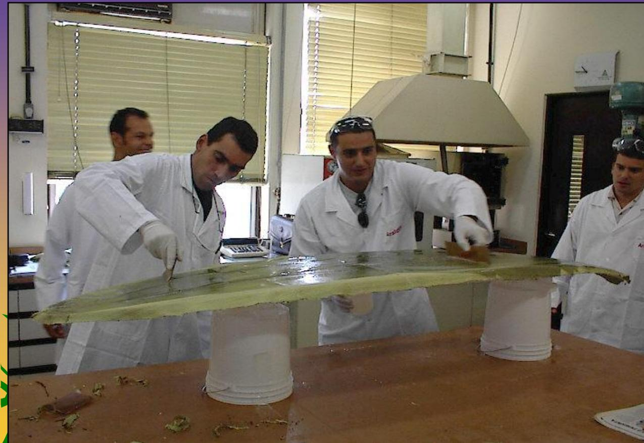
**.Araldite XR-1553 e Endur. XR-1943 (100 : 20 pp.) é um excelente sistema de laminação, epoxi especialmente para carbono ou kevlar.**
